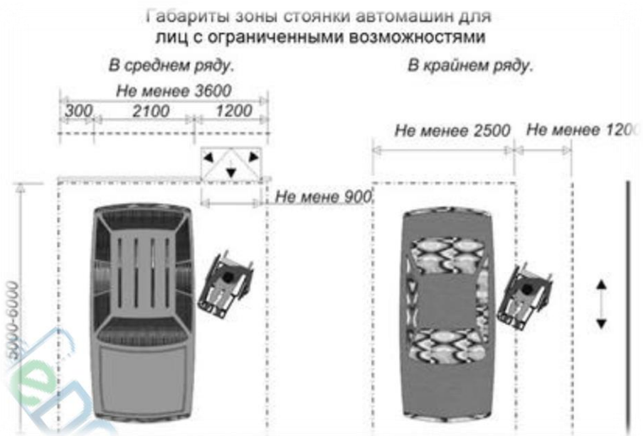
Рисунок № 9: Габариты зоны стоянки автомашин для ЛОВ, источник: СП С.01.02:2018, Рисунок С.7
