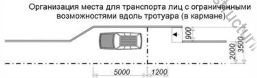
Рисунок № 10: Организация места для транспорта лиц с ограниченными возможностями вдоль тротуара (в кармане), источник: СП С.01.02:2018, Рисунок С.7
